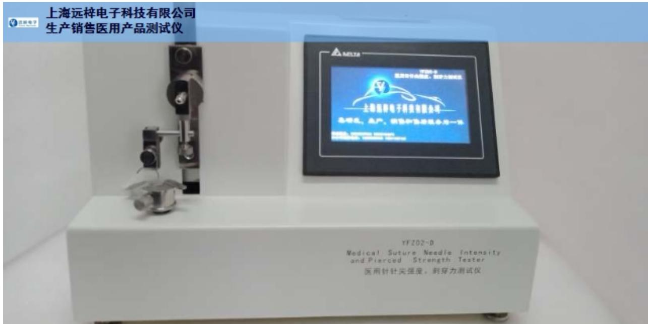
上海远梓电子科技有限公司(以下简称“远梓电子”)成立于2006年,是一家集研发、制造、销售为一体的综合性医用检测仪器设备的高科技企业。公司产品广泛应用于医用产品的各类物理性能测试、检验、分析和研究;汽车产品的测试设备;汽车制动软管的组装及性能实验设备以及电子产品检验。采用5.7英寸(320×240)PLC多彩液晶触摸显示屏,中文菜单显示。公称规格、管壁、测试次数、加压、上行、下行、时间、标定。由键盘控制液晶显示屏上的菜单,机载打印测试数据。实时显示刺穿力和峰值力数据,可显示比较大刺穿力及F五种峰值力CL15811-D医用注射针针尖刺穿力测试仪完全符合GB15811-2016《一次性使用无菌注射针》标准中相关条款设计制造。公称规格0.18-3.4mm;测试范围0.01-5.00N误差不大于±1%;移动速度100mm/min;误差不大于±5%;(赠送)模拟皮肤:聚氨酯膜材料,符合GB15811标准。医用针针尖强度、刺穿力测试仪YFZ02-D完全符合“YY0043-2016”的标准设计制造。测试项目:强度、刺穿力;盐城医用采血针针尖刺穿力测试仪厂家
